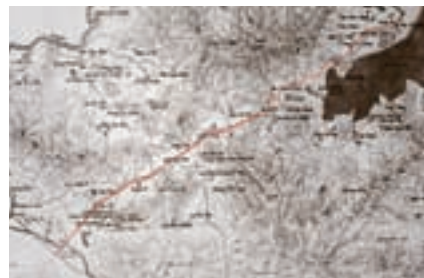
1915年地圖所示的沙頭角支綫定綫。 Alignment of the Sha Tau Kok branch line shown on map dated 1915.
