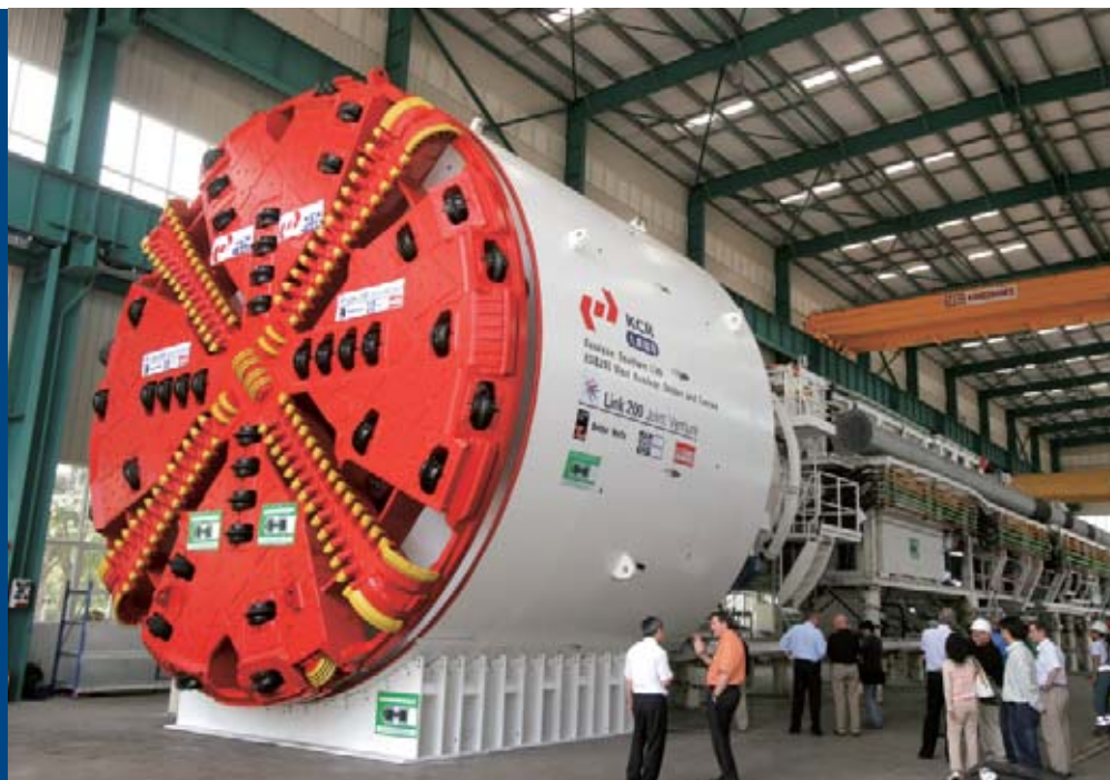
特別為鑽挖九龍南線隧道而設計的隧道鑽挖機。
